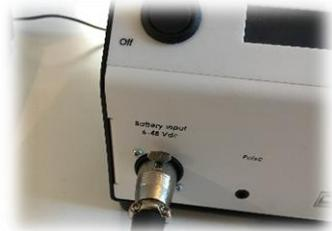
**3) Verbinde den Testkabel mit der Batterie.**
